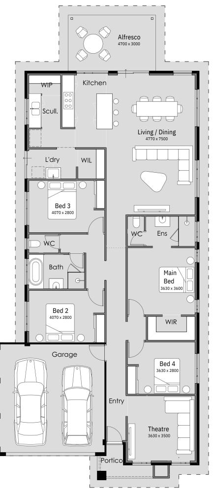
OVERALL WIDTH- 10.89m OVERALL LENGTH- 24.85m MIN BLOCK WIDTH- 12.5m MIN BLOCK LENGTH- 30m TOTAL AREA- 223.03m<sup>2</sup>
