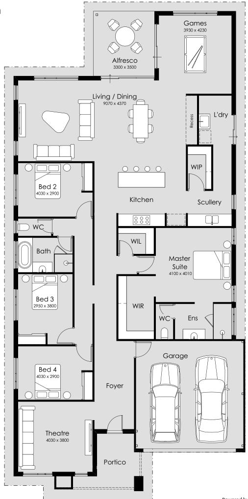
OVERALL WIDTH- 12.49m OVERALL LENGTH- 25.89m TO SUIT BLOCK WIDTH- 15m TO SUIT BLOCK LENGTH- 30m TOTAL AREA- 285.60m<sup>2</sup>
